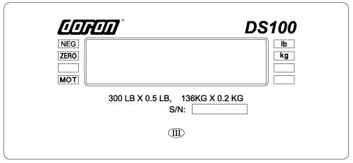
Fig. 2 DS100 Front Panel Remote Display
