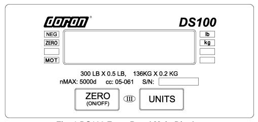
Fig. 1 DS100 Front Panel Main Display
